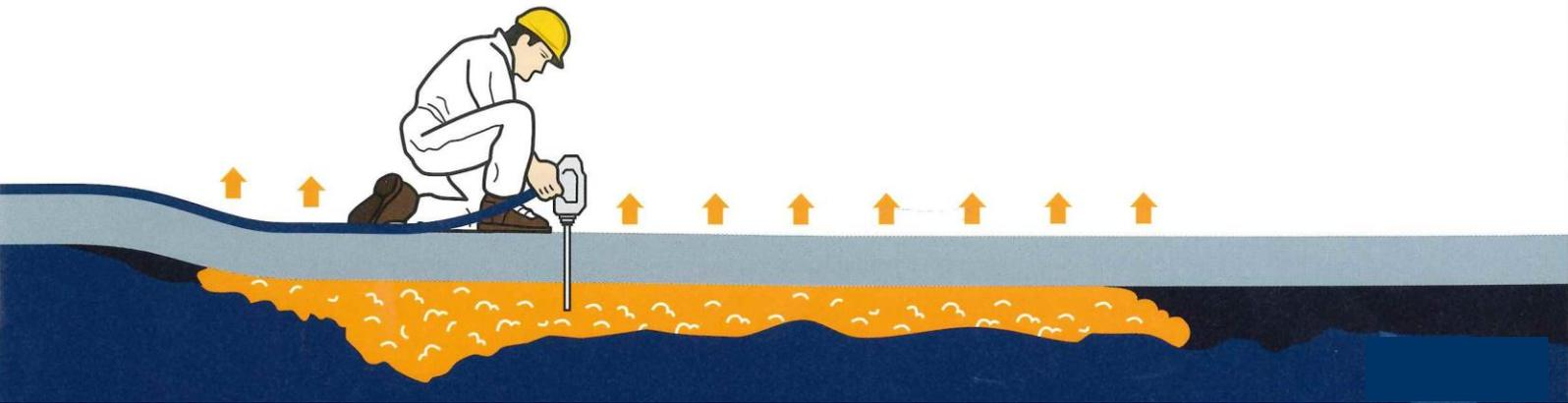
メインマーク株式会社が行うウレタン樹脂注入による「沈下床の修正工法」は特許工法です。
